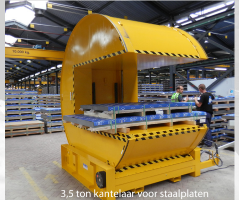
3,5 tons kantelaar voor panelen in combinatie met vacuümunit
